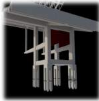
Gambar 5.13: Pondasi Bore Pile Sumber : Hasil Olahan Penulis, 2022
