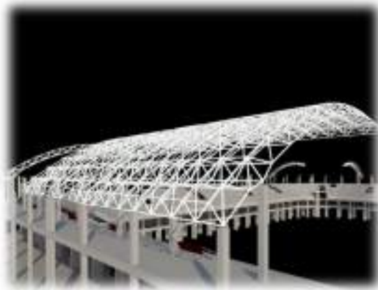
Gambar 5.15 : Sistem Struktur Rangka Ruang (Space Frame) Sumber : Hasil Olahan Penulis, 2022
