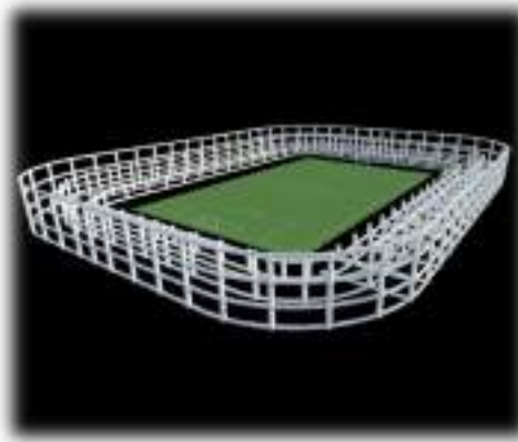
Gambar 5.14 : Sistem Struktur Rigid Frame Sumber : Hasil Olahan Penulis, 2022
