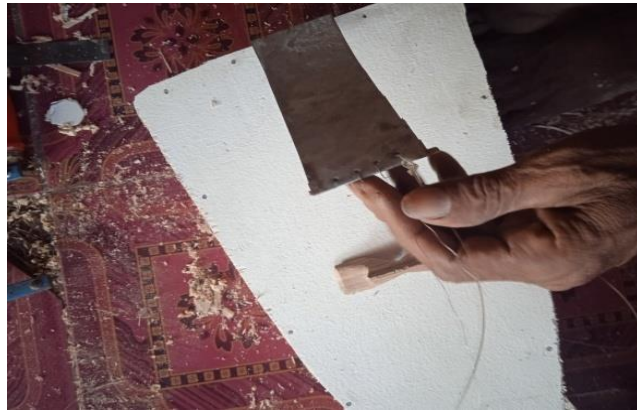
Gambar 4.23 Pemasangan senar pada tile pice Sumber : Dok. Vena 2022
