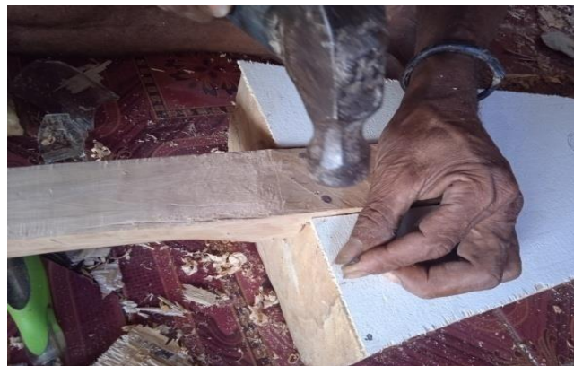
Gambar 4.22 Proses penyatuan triplek dengan body Sumber : Dok. Vena 2022
