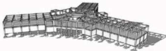
Gambar 97. Struktur rigid frame (sumber: olahan penulis)
