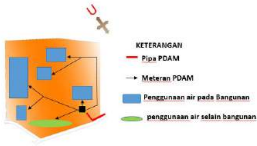
Gambar 30. Sistem Jaringan Air Bersih pada Tapak
