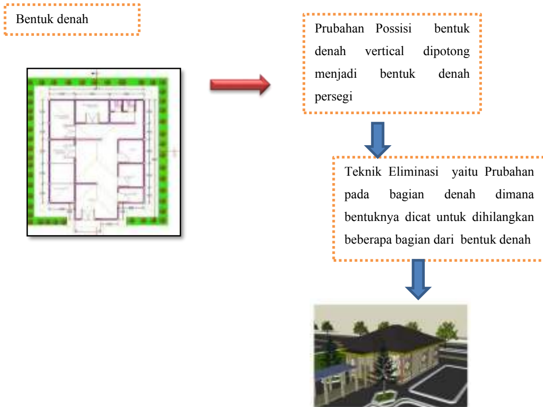
Gambar 5.8 Pengubahan Bangunan Instalasi Gisi
