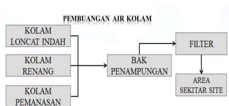
Bagan 5.4 ; konsep pembuangan air kolam
