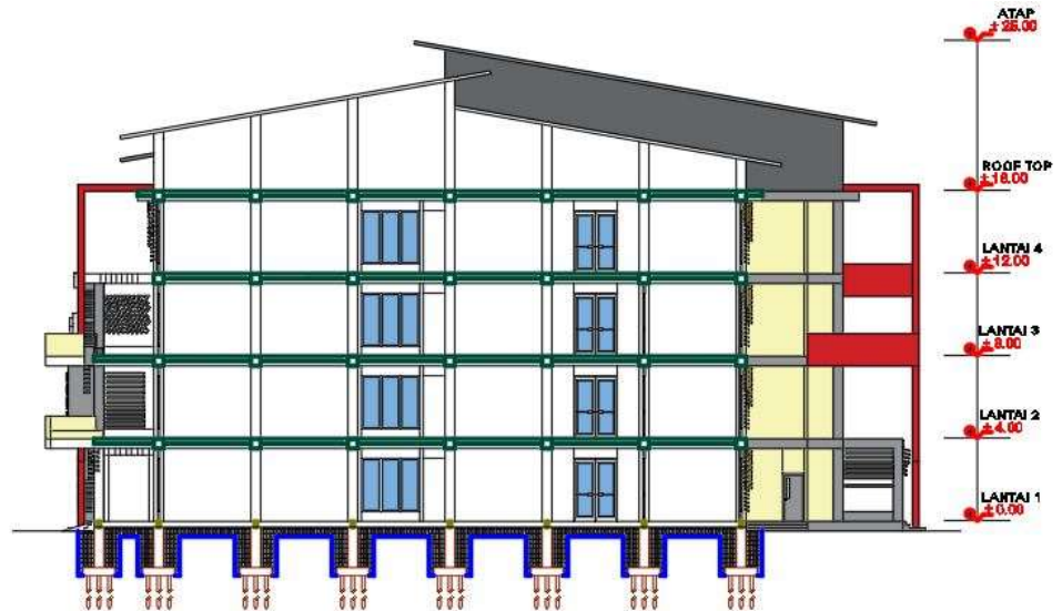
Gambar 5.31 Menggunakan Pondasi Tiang Pancang dan Footplat
