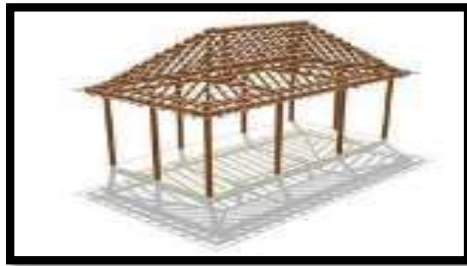
Gambar V.26 Konsep Struktur Atap Rangka Kayu
