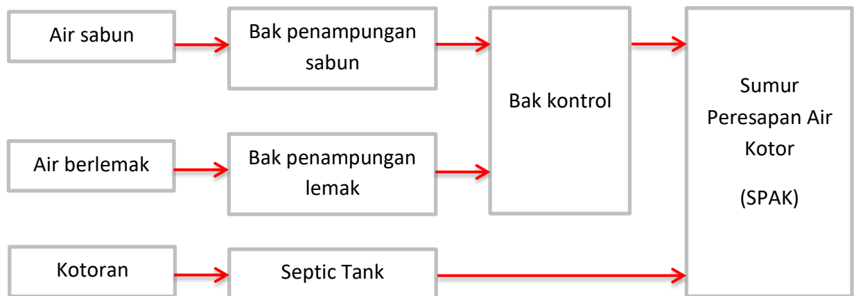
Bagan 4.10 Alternatif Bagan Sistem Distribusi Air Kotor
