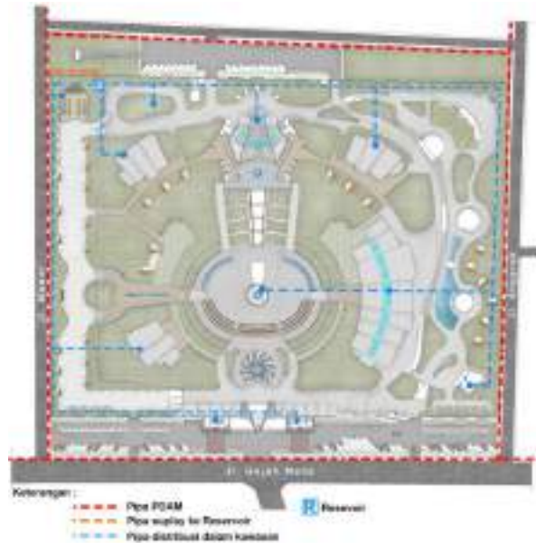
Gambar 5. 64 Konsep sistem distribusi jaringan air bersih pada kawasan Sumber : Analisa Penulis, 2020
