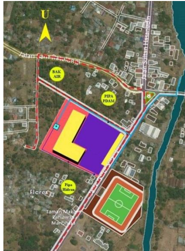
Gambar 5. 9 Penempatan hidran pada tapak
