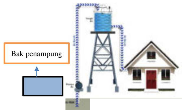
Gambar 1 Sistem distribusi air bersih
