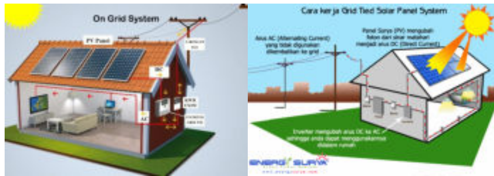
Gambar 1 Listrik pada bangunan
