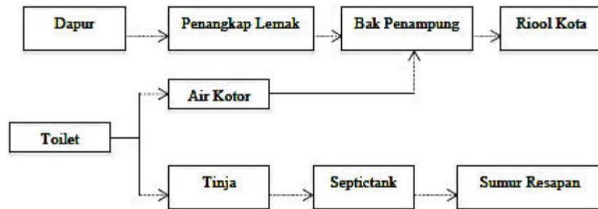
Gambar 5. 26 Skema pembuangan kotoran (Sumber : Hasil analisa penulis, 2020)
