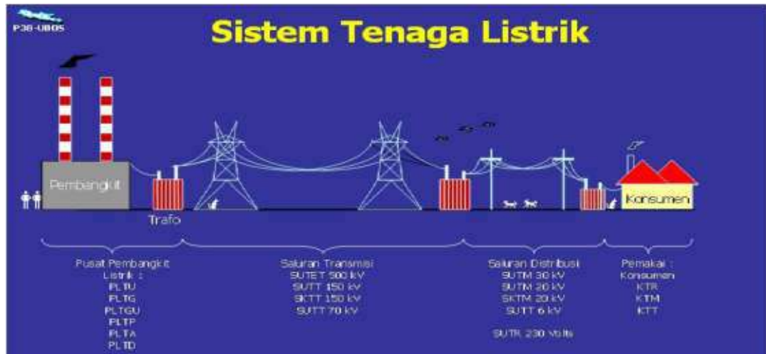
Bagan 1 Sistem distribusi listrik pada tapak
