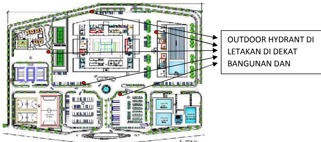
Gambar 5.12 sistem pemadam kebakaran
