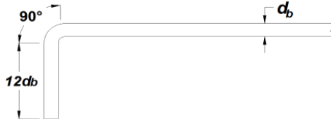
Gambar 2.20. Kait Standar Bengkokan 90 Derajat Sumber Gambar : Konsep SNI 03-2847-2013
