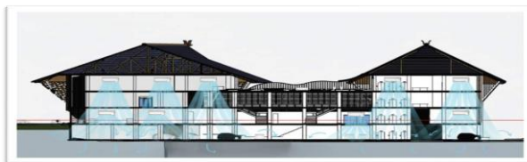
Gambar 5.19. konsep penghawan buatan gedung
