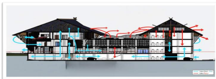
Gambar 5.18. konsep penghawan alami gedung
