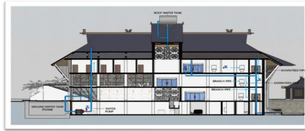
Gambar 5.22. konsep air bersih pada gedung
