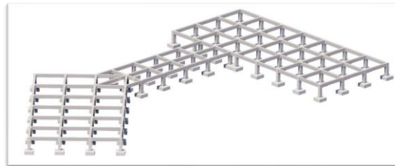
Gambar 5.16. Struktur Gedung Kesenian
