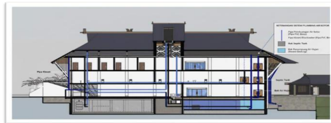
Gambar 5.23. konsep air kotor pada gedung
