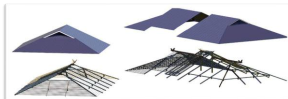
Gambar 5.14. Struktur Gedung Kesenian
