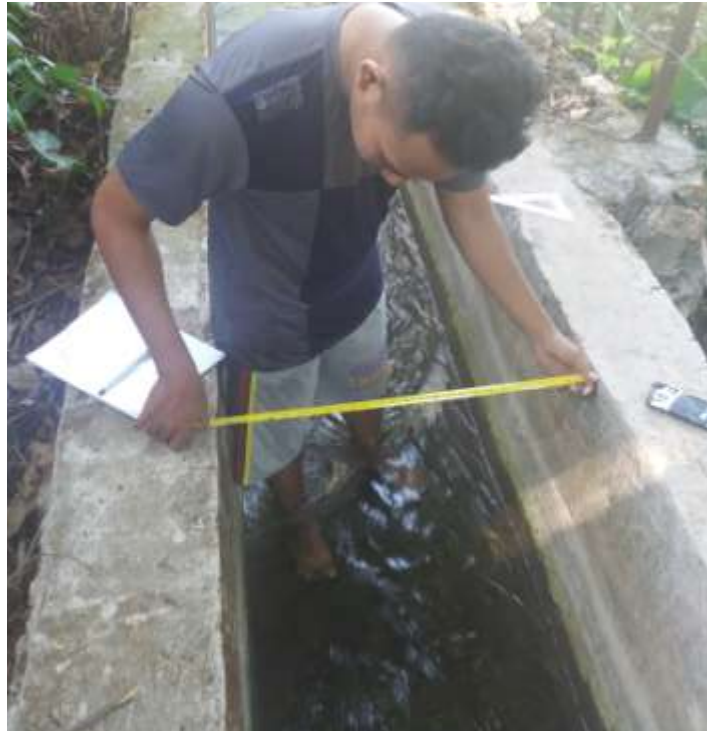
Gambar 4.3 Pengukuran Dimensi Jaringan Untuk Mengukur Debit
