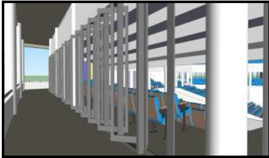
Gambar 104 : Bukaan berupa jendela putar untuk pengudaraan alami pada bangunan.
