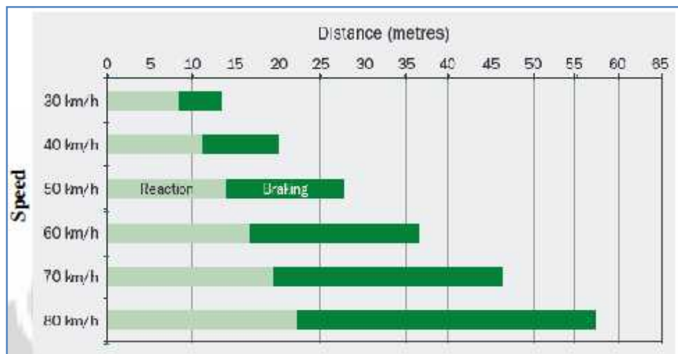
Gambar 2.3 Ilustrasi jarak henti pada pengereman mendadak
