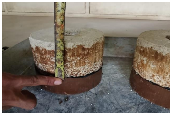
Gambar 4.13 Hasil Pengukuran Sampel Pemadatan Batu Kapur dengan Separator Plastik
