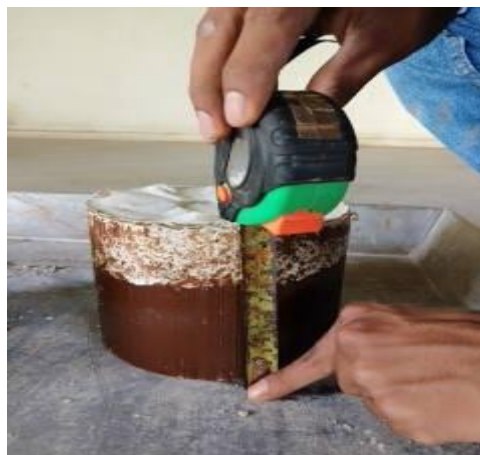
Gambar 4.10 Hasil Pengukuran Sampel Tanah Lunak setelah dipadatkan
