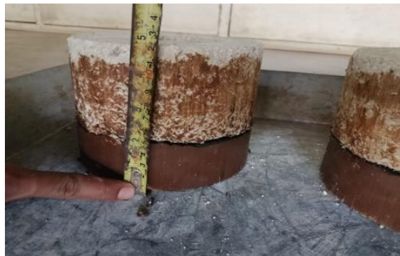
Gambar 4.12 Hasil Pengukuran Sampel Pemadatan Menggunakan Seprator Plastik
