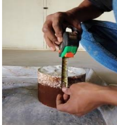
Gambar 4.9 Hasil Pengukuran sampel Batu Kapur setelah dipadatkan
