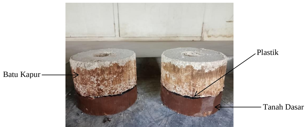
Gambar 4.11 Pemadatan Sampel dengan menggunakan Separator Plastik Sumber: Hasil Pengujian Laboratorium Teknik Sipil UNWIRA 2023
