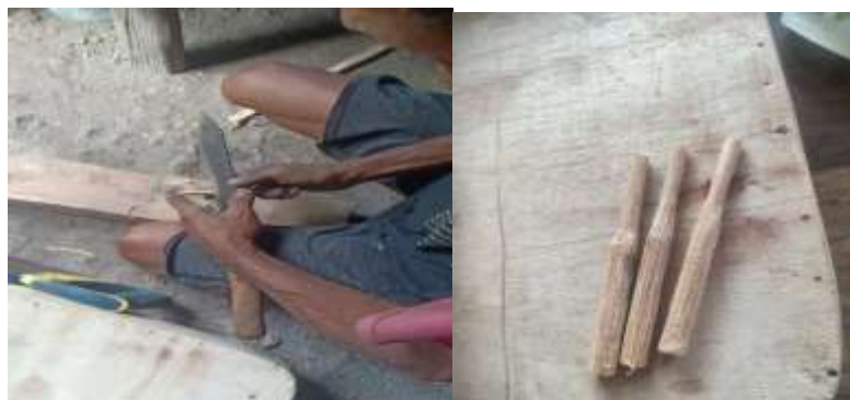
Gambar 4.26: proses pembentukan Bradan Sumber: Dok.Alexis 02/4/2024
