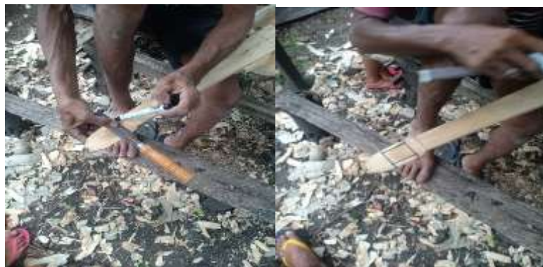
Gambar 4.23: proses pembentuka pola bradan Fatin Sumber: Dok.Alexis 01/04/2024
