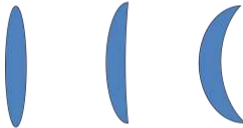
Gambar 2.21 Lensa Bikonveks, Plankonveks, dan Konveks
