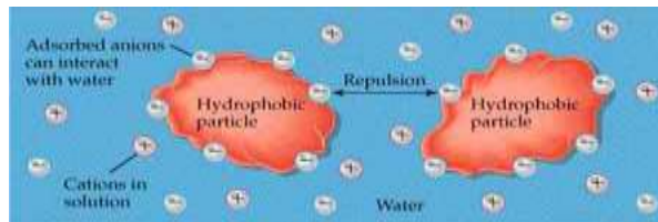
Gambar 2.3 Adsorpsi ion oleh partikel koloid
