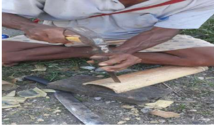
Gambar 4.20. Proses menandai sisi depan bambu Dok. Johan November 2022
