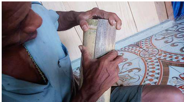
Gambar 4.23. proses penggabungan kedua sisi bambu Dok. Johan November 2022
