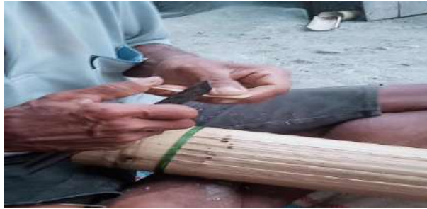
Gambar 4.26. Proses pembuatan pik Dok. Johan November 2022
