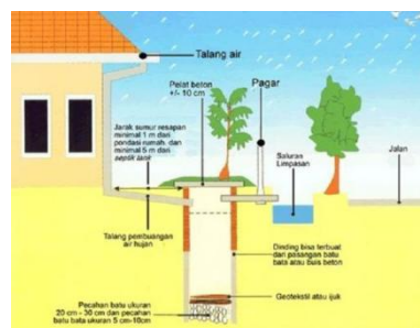
Gambar 82. Sumur resapan dan drainase dengan penutup Sumber : sumur resapan dan operasi dan pemeliharaan sistem drainase perkotaan
