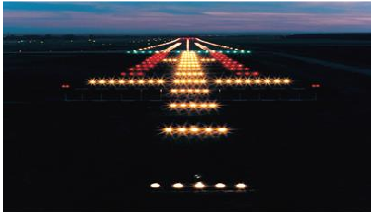
Gambar 13 Sistem Pencahayaan Pada Runway
