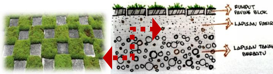
Gambar. 5.14. Perkerasan paving blok (Sumber: Analisa Penulis),2015
